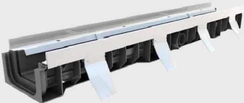
Opremljen MONOBLOK okvirom od pocincanog ili nehrđajućeg čelika s 8 vanjskih produžetaka (4 sa svake strane), za bolje spajanje s betonom, garantira stabilnost i otpornost na savijanje.
